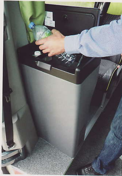
Wo sonst Rückhaltewände stehen, findet hier selbst auf engstem Raum noch ein relativ geräumiger Kühlschrank seinen Platz.
