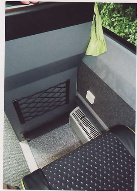
Ein 230-Volt-Anschluss für Laptops gehört schon fast zum Standard. Im Super Crafter steht er dem Fahrgast in der ersten Reihe rechts zur Verfügung.
