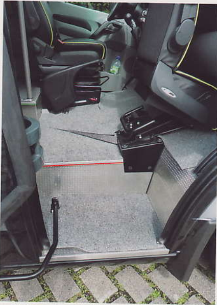
Der tiefere Einstieg bietet den Mitreisenden einen bequemen Zugang. Werksseitig fährt hier beim Öffnen der Tür eine zusätzliche Ausstiegsstufe aus. Durch das Abflachen des Fahrerbodens entfallen gefährliche Stolperschwellen im Einstiegsbereich.
